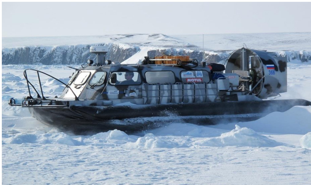
Рис.7 Опытный образец быстроходного амфибийного поисково-спасательного судна для оснащения ледоколов и экспедиционных спасательных центров в Арктике
