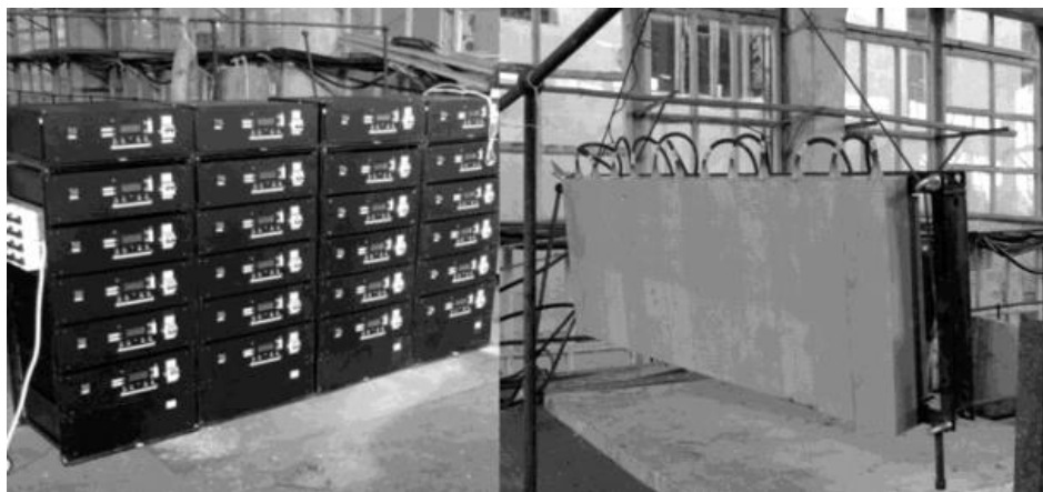
Рисунок 3 – Гидроакустическая параметрическая антенна мониторинга океана на протяженных трассах. Слева – 24 канальный усилитель мощности антенны
